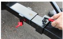
手順① セーフティーロックを取り外します ※トレーラーと牽引車がしっかりと連結 されていることを確認下さい!
