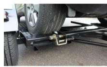
**手順⑥** ベルト固定用ラッシングステーをタイヤ 中心にベルトでタイヤを固定します
