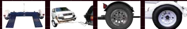
しっかりとしたフレームで4WD車両も運搬! | タイヤは付属のラッシングキットにより、簡単に固定できます | プレミアムモデルはクロームメッキホイールを標準装備! | ニップル付きによりグリスアップで簡単にグリスアップ可能
